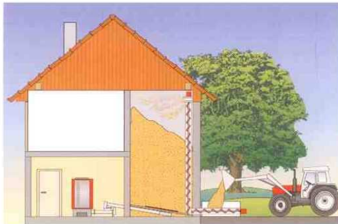
Grand silo de plain-pied avec remplissage par vis verticale.
