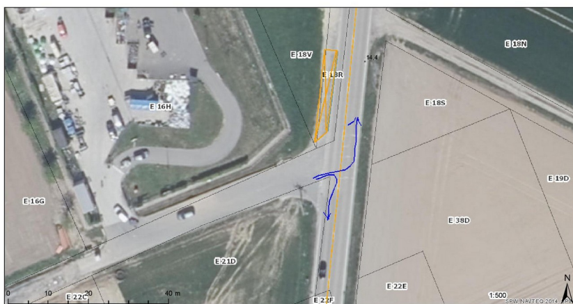
Stationnement (en orange) bloquant la visibilité en sortie de la rue Mallay : le tourne à gauche et le tourne à droite (en bleu).
